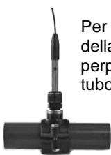
Per una lettura ottimale della sonda, posizionarla perpendicolarmente al tubo.
