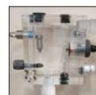
Sonda amperométrica para cloro libre
